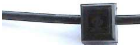
شکل ۴- آهنرباهای ثابت نصب شده به دور لوله پلی اتیلن ۱۶ میلی متری
