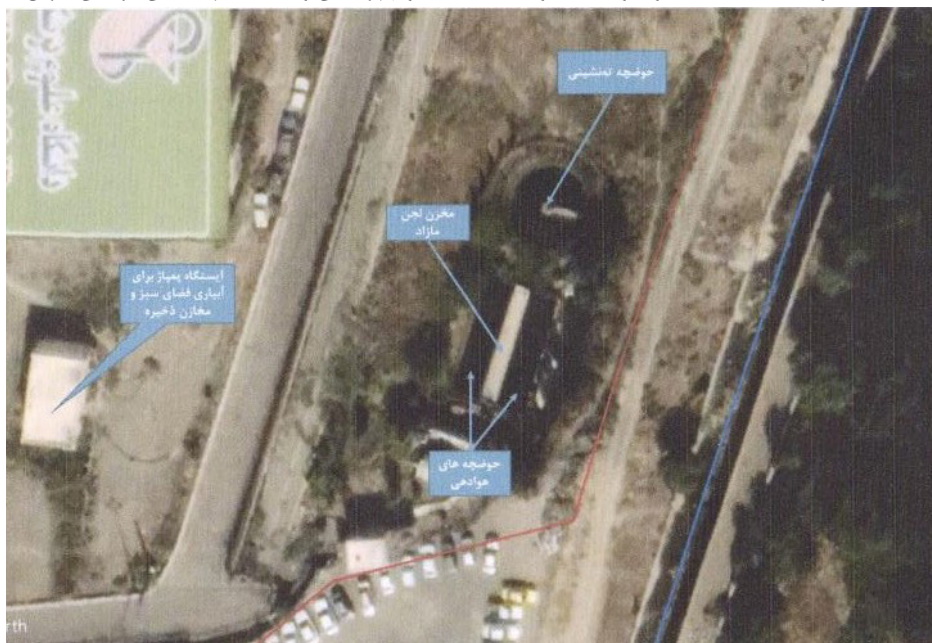
شکل ۲- موقعیت حوضچه هوا دهی، ته نشینی و مخزن لجن مازاد
