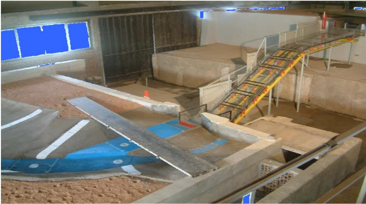
شکل ۳. مدل هیدرولیکی سرریز سد نازلو (بی‌نام، ۱۳۸۶)
