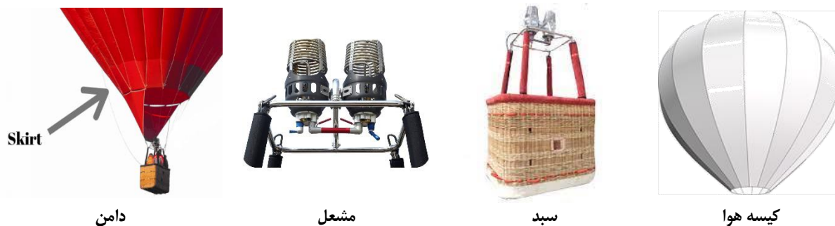
شکل ۳- برخی اجزای ساختاری یک بالن
