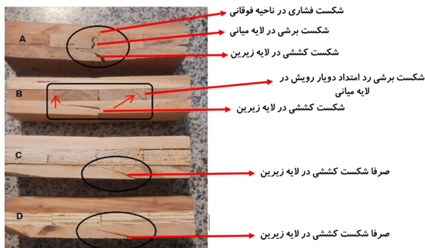
شکل ۱۱. مد شکست نمونه‌های CLT تحت بار خمشی استاتیک
