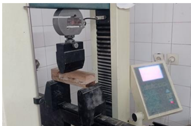
شکل ۴. انجام آزمون خمش بر روی نمونه‌های CLT
