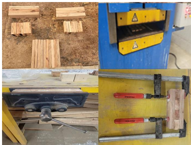
شکل ۲. مراحل برشکاری، فشرده‌سازی و ساخت نمونه‌های CLT، کارگاه صنایع چوب دانشگاه زابل
