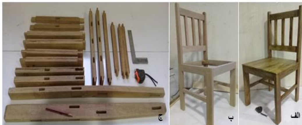
شکل ۲. الف) صندلی نهایی، ب) صندلی مونتاژ شده و ج) قطعات صندلی قبل از مونتاژ
