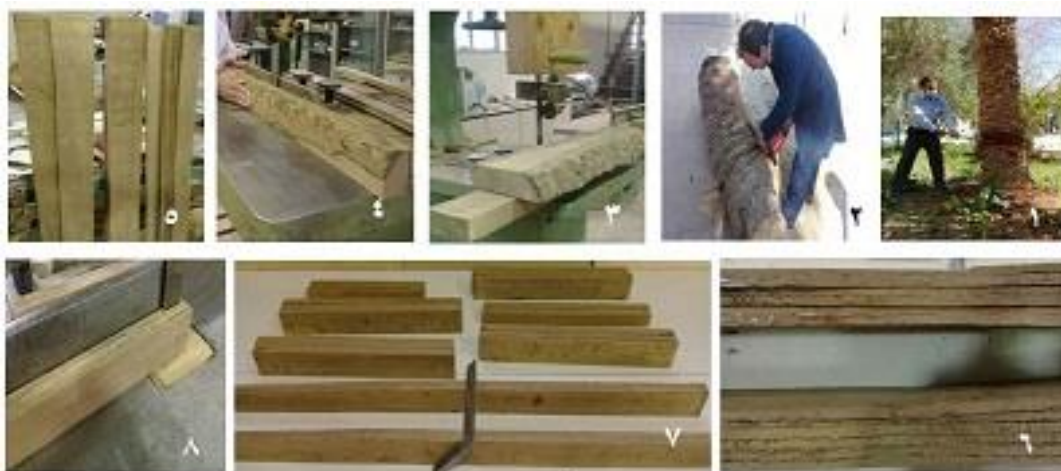
شکل ۱. قطع نخل خرما خشک (۱)، اندازه بری با اهر زنجیری (۲)، تبدیل نخل خرما به چهار تراش (۳)، لایه‌گیری به اهر نواری (۴)، لایه‌های آماده جهت اصلاح حرارتی (۵)، ساخت الوار لایه‌ای چند سازه از نخل خرما با پرس گرم (۶)، اندازه بری و آماده‌سازی قطعات صندلی (۷)، ساخت اتصالات (۸).
