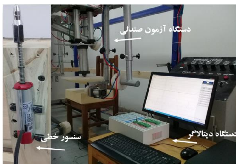
شکل ۳. دستگاه دیتا لاگر و دستگاه تست صندلی در اتاق تست و سنسور خطی (پتانسیومتر)
