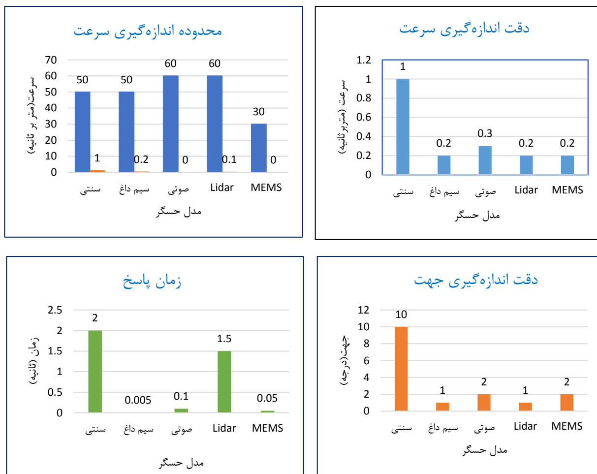
شکل ۷. مقایسه محدوده اندازه‌گیری، دقت اندازه‌گیری سرعت و جهت و زمان پاسخ حسگرهای مختلف
