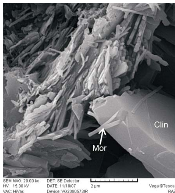
شکل ۲- تصویر SEM نمونه اولیه Clin: نشان دهنده کانی کلینوپتیلولیت، Mor: نشان دهنده کانی موردنیت
