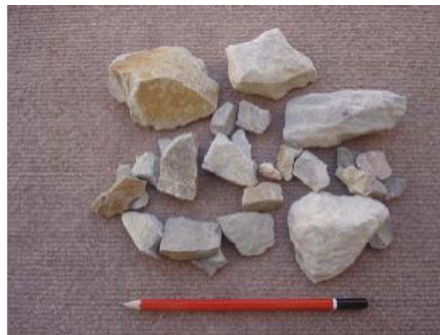
شکل ۱: نمونه مصالح شکسته گوشه‌دار مورد استفاده در نمونه‌ها.
