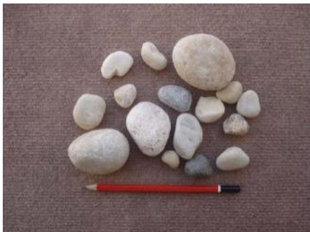
شکل ۲: نمونه مصالح گردگوشه رودخانه‌ای مورد استفاده در نمونه‌ها.
