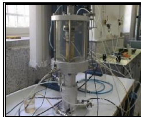
شکل ۴: دستگاه سه‌محوری مسیر تنش بیشاپ-وسلی.
