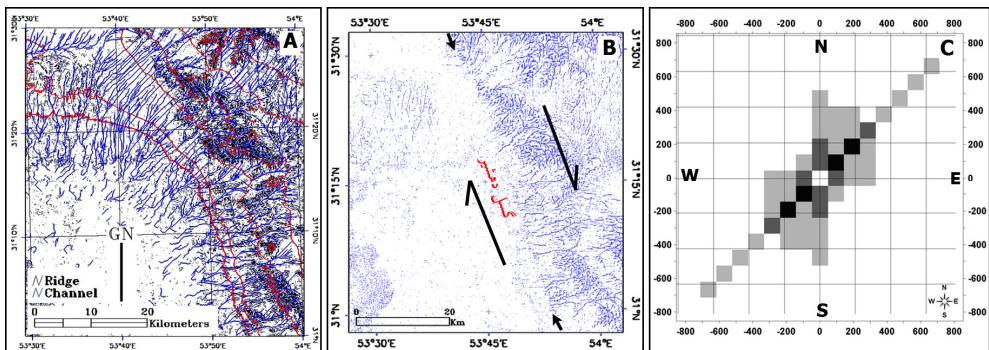
شکل ۱۵. تجزیه و تحلیل شبکه زهکشی در ناحیه دهشیر (A) شبکه زهکشی استخراج شده از SRTM - خطوط ممتد منحنی تراز را نشان می دهد، (B) تأثیر تکتونیک گسل دهشیر بر شبکه زهکشی (قطع، جابجاشدگی، انحراف) در امتداد گسل دهشیر، (C) سطح واریوگرام نقشه شبکه زهکشی استخراج شده از SRTM بیانگر غلبه شبکه های زهکشی در جهات NE-SW در ناحیه دهشیر می باشد.
