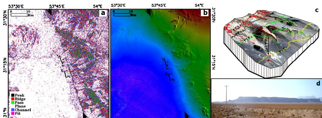
شکل ۱۹. (a) اشکال توپوگرافیک (قله، پسته‌ها و میان‌آبهای گردنه‌ها، سطوح هموار، بستر زهکش‌ها، گودال‌ها) در ناحیه دهشیر استخراج شده از SRTM (b) تصویر سایه‌دار استخراج شده از SRTM ناحیه دهشیر و موقع اثرگسل دهشیر، (c) تصویر ۱۲۳ Aster همپوشانی شده بر روی SRTM سطوح فرسایشی شرق دهشیر را نشان می‌دهند، عکس صحراوی یکی از سطوح فرسایشی در شرق دهشیر
