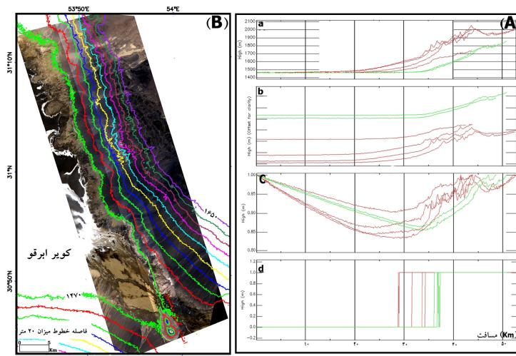
شکل ۹. (A) تکنیک‌های مختلف ترسیم پروفیل: a) نرمال b) طبقه‌بندی بدون همپوشانی<sup>۱</sup> c) طبقه‌بندی زنجیروار<sup>۲</sup> d) طبقه‌بندی دوگانه<sup>۳</sup> ، (B) منحنی‌های میزان استخراج شده از SRTM Aster123 که بر روی تصویر گسل دهشیر همپوشانی شده‌اند،
