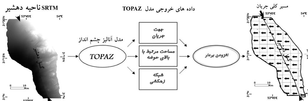
شکل ۳ . مدل توپاز (TOographic PArameteriZation) جهت استخراج شبکه زهکشی رقومی ناحیه دهشیر
