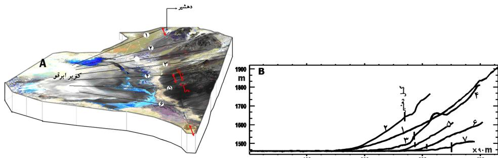
شکل ۸. مدل سه بعدی تصویر ETM<sup>+</sup> ناحیه دهشیر با درجه اغراق ۸ × عمودی (A) و نیمرخ‌های طولی عمود بر امتداد گسل دهشیر (B) (نک (A))
