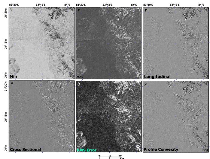
شکل ۱۸. مدل‌های توپوگرافی ناحیه دهشیر (استخراج شده از SRTM) و نقش آنها در بازیابی عناصر خطی و خطواره‌ها ناحیه دهشیر
