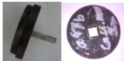
شکل ۹: آزمایش اکستروژن بیلت دایره‌ای به مقطع مربعی با استفاده از قالب همگرای دوخطی.
