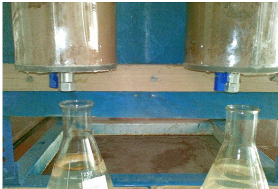
شکل شماره (۳): پایلوت آزمایش و شیرهای نمونه‌گیری
