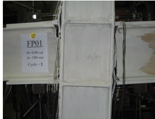
شکل ۱۸: تغییر شکل بیش از حد صفحه روپوش ستون در مدل آزمایشگاهی اتصال متداول [۱۳]
