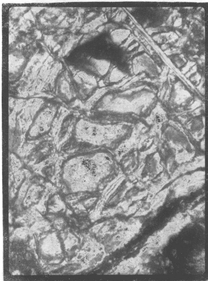
شکل ۱ - سرپانتی نیزاسیون بلورهای اولیون در دونیت فاریاب (۱۳۰X)
