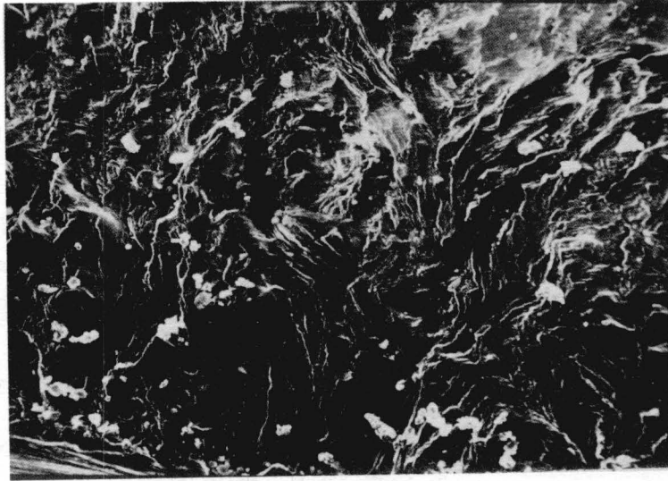
شکل شماره ۳ (بزرگنمایی ۱۶۰۰) مقطع شکست خستگی
