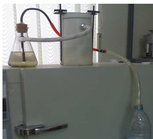
شکل ۱. نمای از سیستم آزمایشگاهی تولید بیوگاز (به ترتیب از چپ: جمع‌کننده بیوگاز، مخزن هضم بی‌هوازی، جمع‌کننده آب خروجی معادل مقدار بیوگاز تولیدشده)
