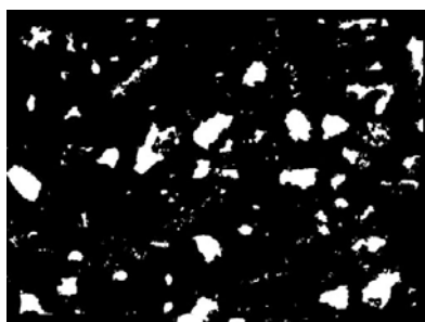
شکل ۷. پردازش تصویر مقطع نازک و حذف تخلخل بین بلوری از تصویر.
