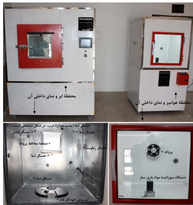
شکل ۱. تصاویری از محفظه ابر و محفظه هوامیز و محل حسگرها.
