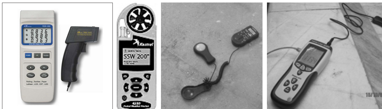
تصویر ۴- دستگاه های اندازه گیری دما و نور، به ترتیب از راست به چپ: نورسنج دیجیتال ۵ ، نورسنج دستی ۲ ، دستگاه هواشناسی کستزل ۳ ، دستگاه آنالیز رنگ ۴ .
