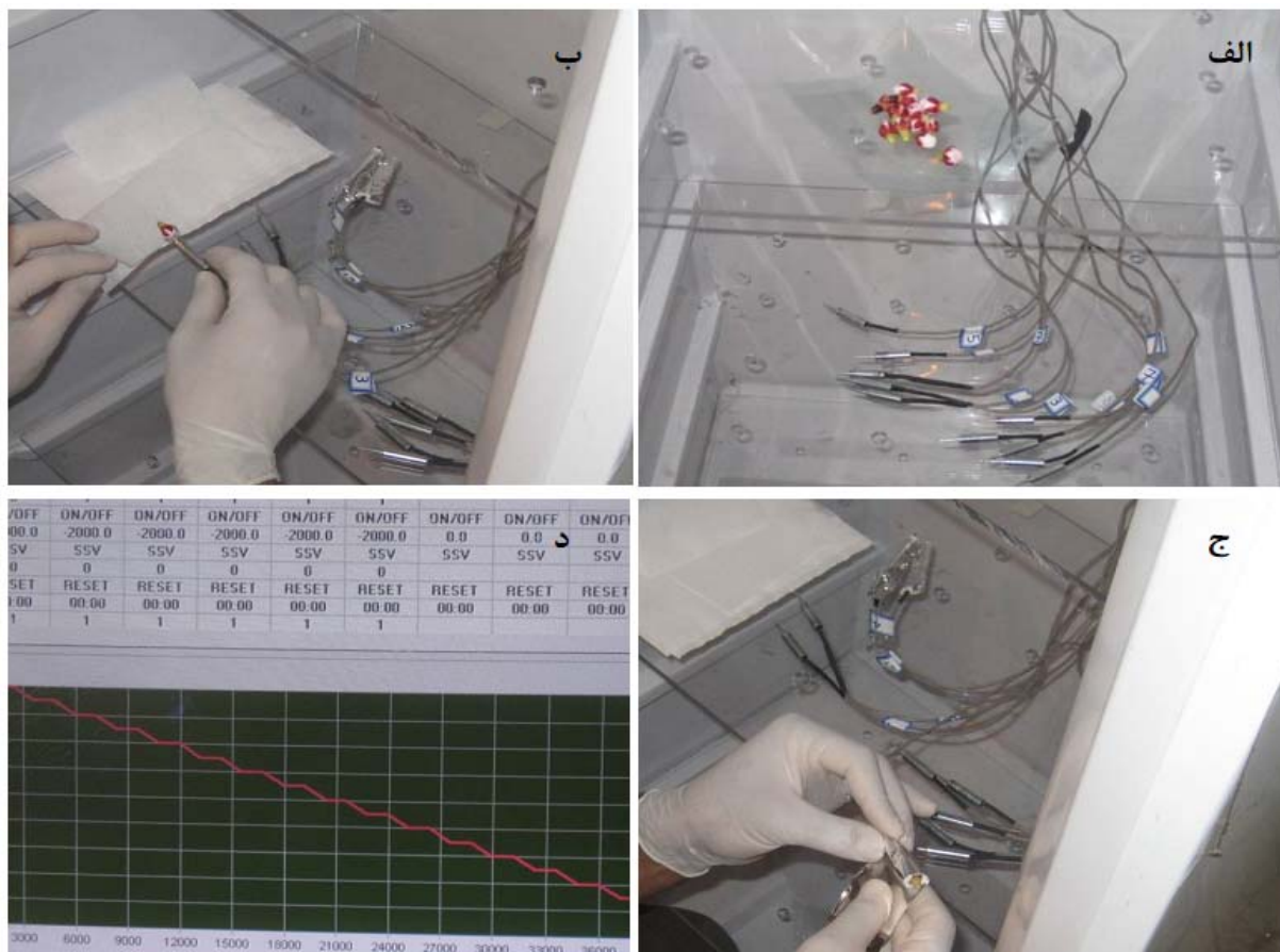
شکل ۱. حسگرهای دمایی استفاده شده متصل به رابط سوزنی (الف)، قراردادن رابط سوزنی در داخل جام گل و پوشش دستمال کاغذی به دور آن (ب)، استفاده از ورق آلومینیوم برای ثابت نگه داشتن گل، حسگر و دستمال کاغذی (ج)، و نمودار نحوه کاهش دما توسط فریزر تحت کنترل نرم افزار NP-200 (د).
