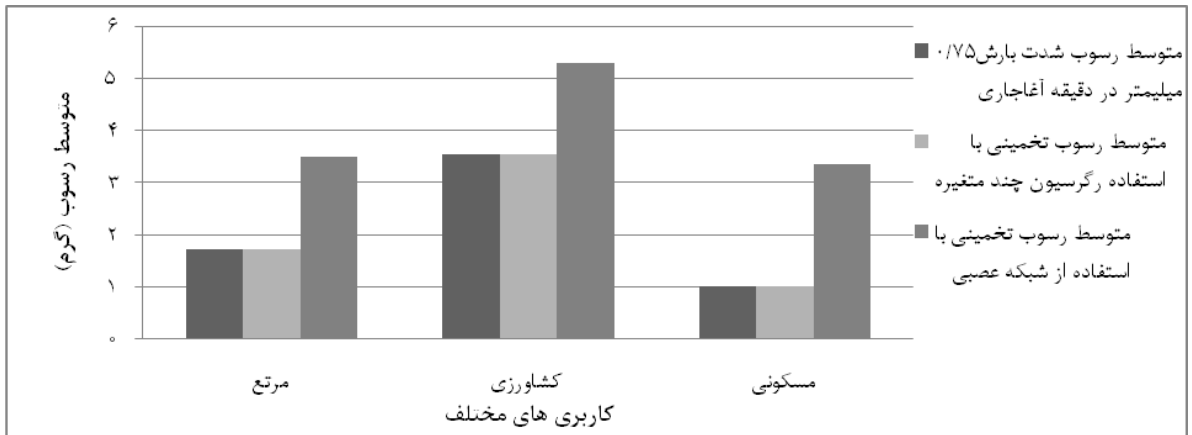
شکل ۲. مقایسه رسوب مشاهده‌ای و تخمینی در شدت بارش ۰/۷۵ میلی‌متر در دقیقه
