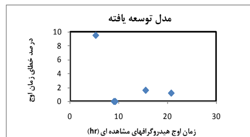
شکل ۱۱. پراکندگی حول خط صفر برای فاکتور درصد خطای زمان وقوع دبی اوج در مدل توسعه یافته
