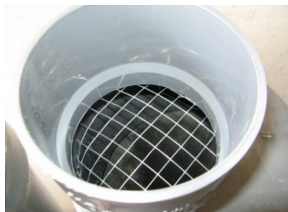
شکل ۲. توری فلزی قرارداده شده در انتهای ستون‌های خاک برای جلوگیری از خروج اجزای فیلتر سنی
