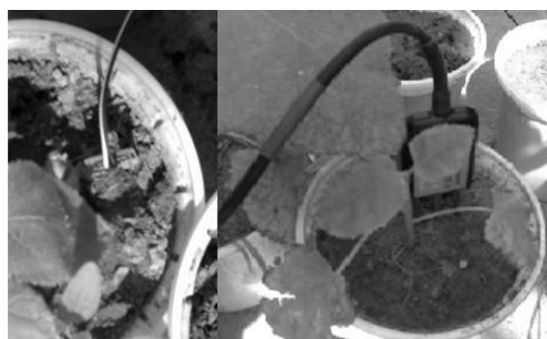
شکل ۵. نحوه قرارگیری دو سنسور در داخل خاک
