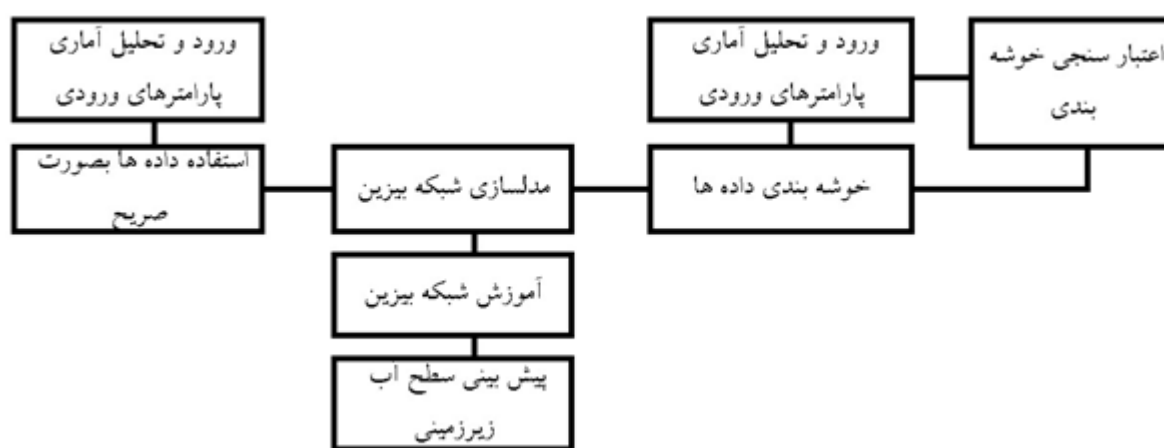
شکل ۳. فلوجارت روند مدل‌سازی شبکه بیزین برای پیش‌بینی سطح آب زیرزمینی
