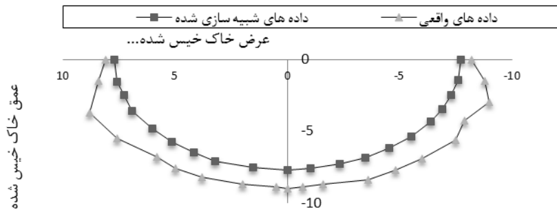
شکل ۴. مقایسه و گسترده‌گی پیاز رطوبتی در شیب صفر برای داده‌های مشاهداتی و داده‌های به دست آمده از مدل هایدروس دوبعدی
