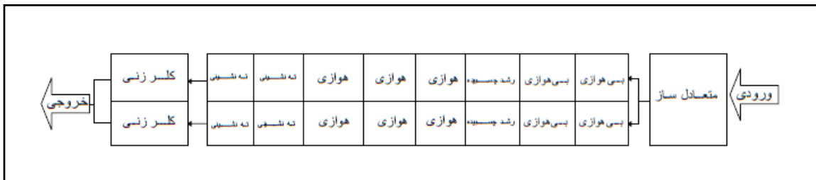
شکل ۱. طرح شماتیک تصفیه خانه شهرک صنعتی نصیرآباد
