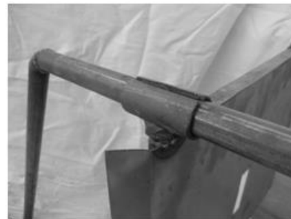
شکل ۳. نحوه حرکت افقی صفحات متراکم‌کننده بر روی قاب دستگاه
