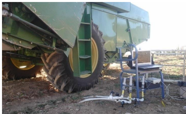
شکل ۶- حسگرهای بولینگ نصب شده در آزمون عبور کمباین
