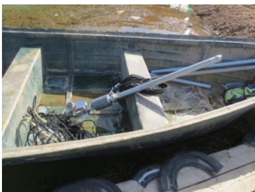
شکل ۲. دستگاه مغزه‌گیر رسوبات مخزن سد و قایق استفاده‌شده
