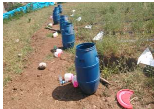
شکل ۴- برداشت نمونه‌های آب جمع‌آوری‌شده در مخازن انتهای کرت‌های آزمایشی و انتقال آن‌ها به آزمایشگاه
