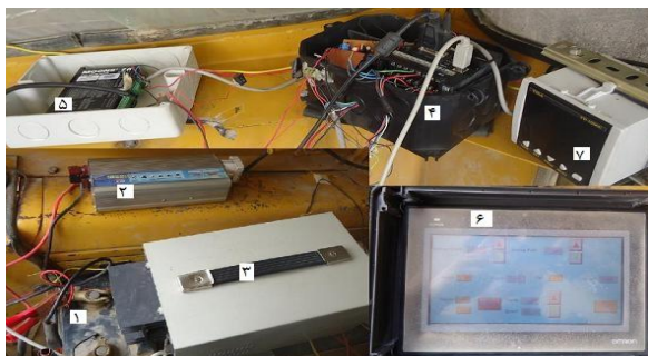
شکل ۴. اجزای واحد کنترل کننده الکتروهیدرولیکی
