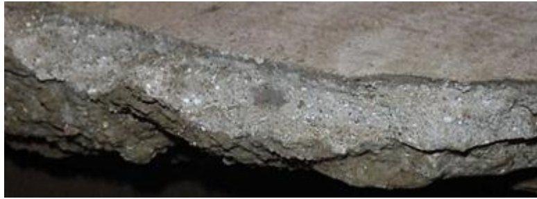
تصویر ۱۱- لایه‌های مختلف نقاشی شهر گور فیروز آباد (لایه رنگ بر روی لایه تدارکاتی گچ اجرا شده)
