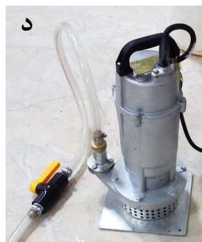
شکل ۱. الف: شبیه ساز باران طراحی شده؛ ب: صفحه بارش؛ ج: فشارسنج؛ د: موتور پمپ التریکی؛ ه: برد کنترلی
