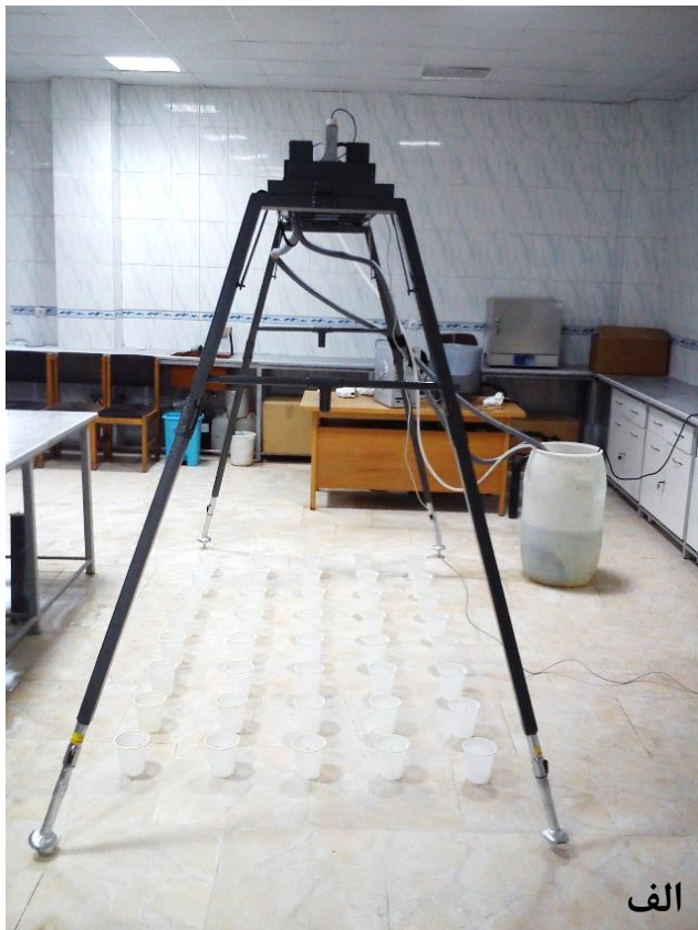
شکل ۱. الف: شبیه ساز باران طراحی شده؛ ب: صفحه بارش؛ ج: فشارسنج؛ د: موتور پمپ التریکی؛ ه: برد کنترلی
