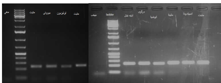
شکل ۱. نتیجه RT-PCR نمونه‌های مادری با پرایمر ویروس ACLS. (ladder مورد استفاده 1KB plus بوده و قطعه cDNA مورد بررسی ۲۱۹ bp بوده است).
