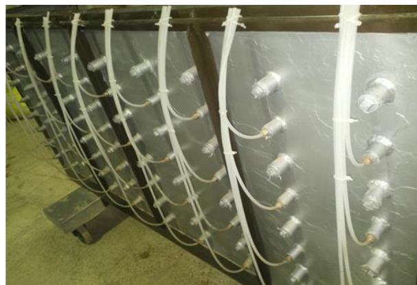
شکل ۳- نمایی از پیزومترها و درپوش‌های نصب شده روی سطح جانبی مدل
