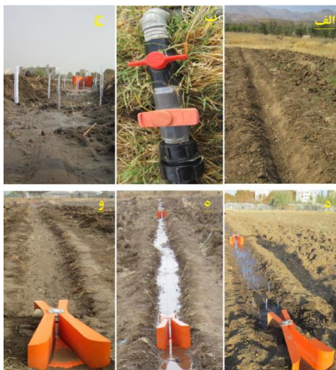
شکل ۴. الف) عملیات احداث شیب ۲ درصد در بستر آبراهه، ب) شیرهای استفاده‌شده برای تولید دبی ورودی یکسان، ج) اشل‌های نصب‌شده برای برداشت محیط خیس شده و سرعت موج سینماتیک، د) انجام آزمایش در طول ۴/۷ متر، ه) انجام آزمایش در طول ۲۰ متر و و) انجام آزمایش در طول ۴۰ متر.
