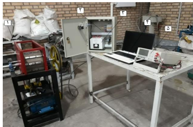
شکل ۴- دستگاه خردکن و اندازه گیری انرژی مصرفی ویژه: ۱- دستگاه خردکن کود دامی مرطوب ۲- تابلو برق ۳- اینورتر ۴- رایانه ۵- دستگاه اندازه گیری توان (power analyzer)
