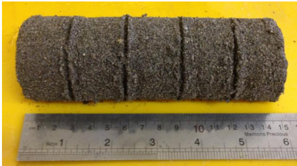
شکل ۲. ستون شن MICCP بریده شده به بخش‌های ۳ سانتی‌متری پس از آب‌شویی
