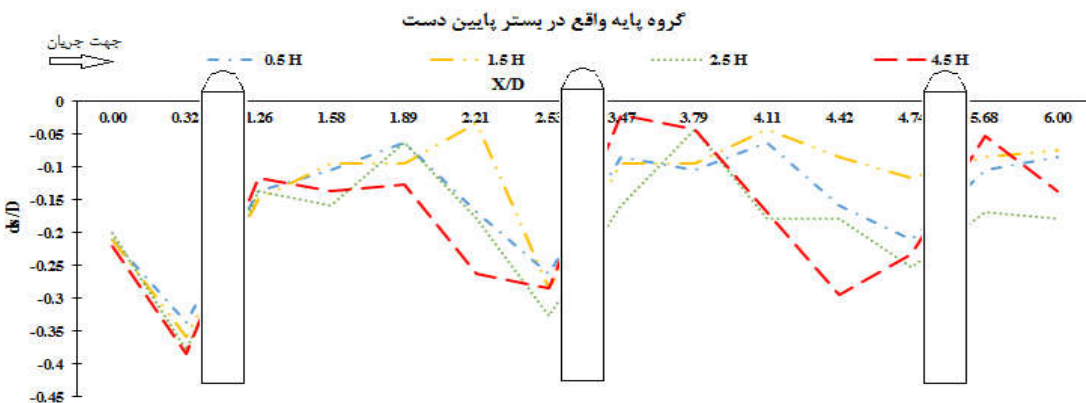
شکل ۱۳- پروفیل طولی آبشستگی بستر بالادست و پایین دست برای عدد فرود ۰/۲۵
