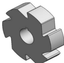
شکل ۴. موزع طراحی شده در نرم‌افزار Solidworks
