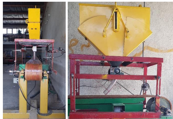
شکل ۲. ب. واحد کارنده مورد استفاده در پژوهش
