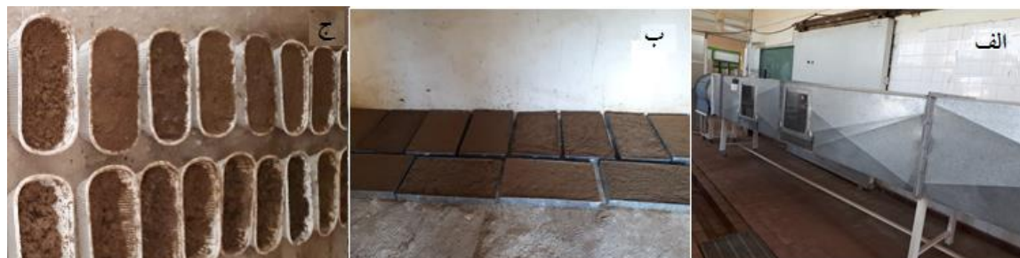
شکل ۱- نمایی از دستگاه تونل باد مورد استفاده (الف)، سینی‌های حاوی خاک پس از اعمال تیمارها (ب)، ظروف پلاستیکی با ابعاد ۲۲۰ × ۱۳۰ × ۵۰ میلی‌متر حاوی خاک پس از اعمال تیمارها (ج).
