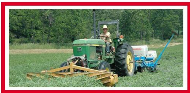
شکل ۴ نحوه عمل غلطک قطع‌کننده در توقف رشد گیاهان پوششی
