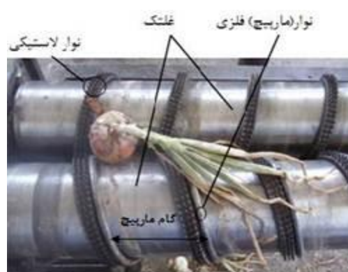
شکل ۱- محل قرارگیری نوار ماریچی فلزی و لاستیکی روی غلتک‌ها
