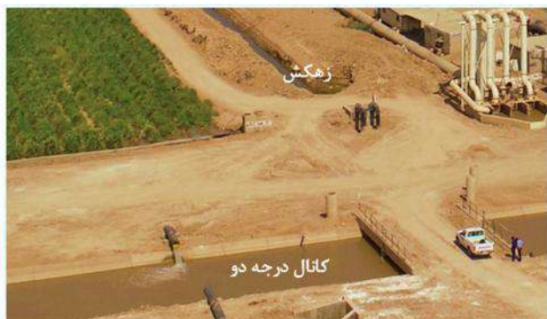
شکل ۳-۶- تصویری از زهکش‌های اطراف مزرعه و اختلاط زهاب با آب غیر شور
