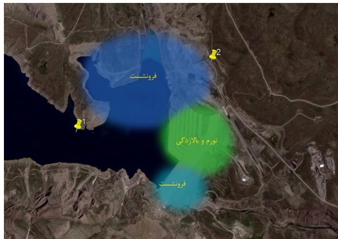
شکل ۹. موقعیت تغییر شکل های قائم رخ داده در بدنه و تکیه گاه سد لار براساس نتایج تداخل سنجی راداری با استفاده از تصاویر Sentinel-1A
