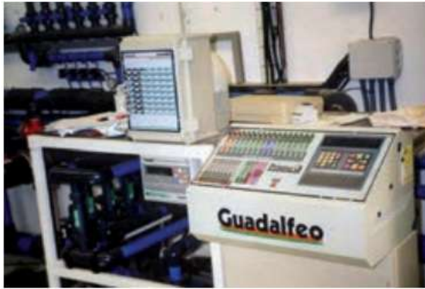
شکل ۲- تجهیزات الکترونیکی یک کنترل کننده کود آبیاری خودکار
