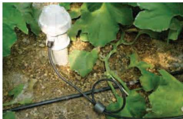
شکل ۳- سنسورهای خازنی EnviroSCAN برای اندازه‌گیری رطوبت حجمی خاک
