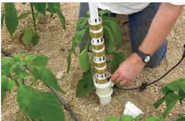
شکل ۳- سنسورهای خازنی EnviroSCAN برای اندازه‌گیری رطوبت حجمی خاک
