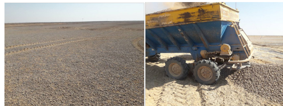
شکل ۱. پاشش سنگریزه با استفاده از کودپاش اصلاح شده
