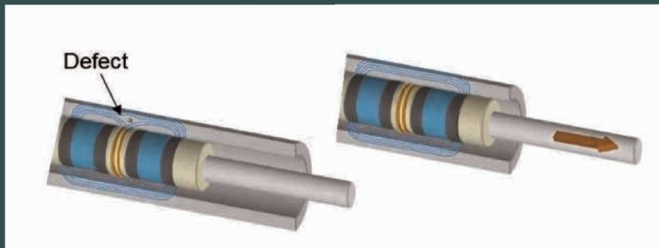
شکل ۲. پروب و نحوه عملکرد آزمایش MFL
